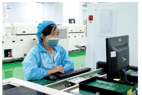
工人通过自动化光学检测系统检测产品质量。
