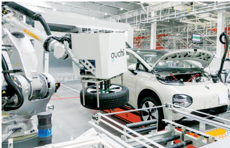
在上汽通用五菱宝骏基地的岛式精益智造工厂，机器人为汽车安装轮胎。全媒体记者 覃科 摄
