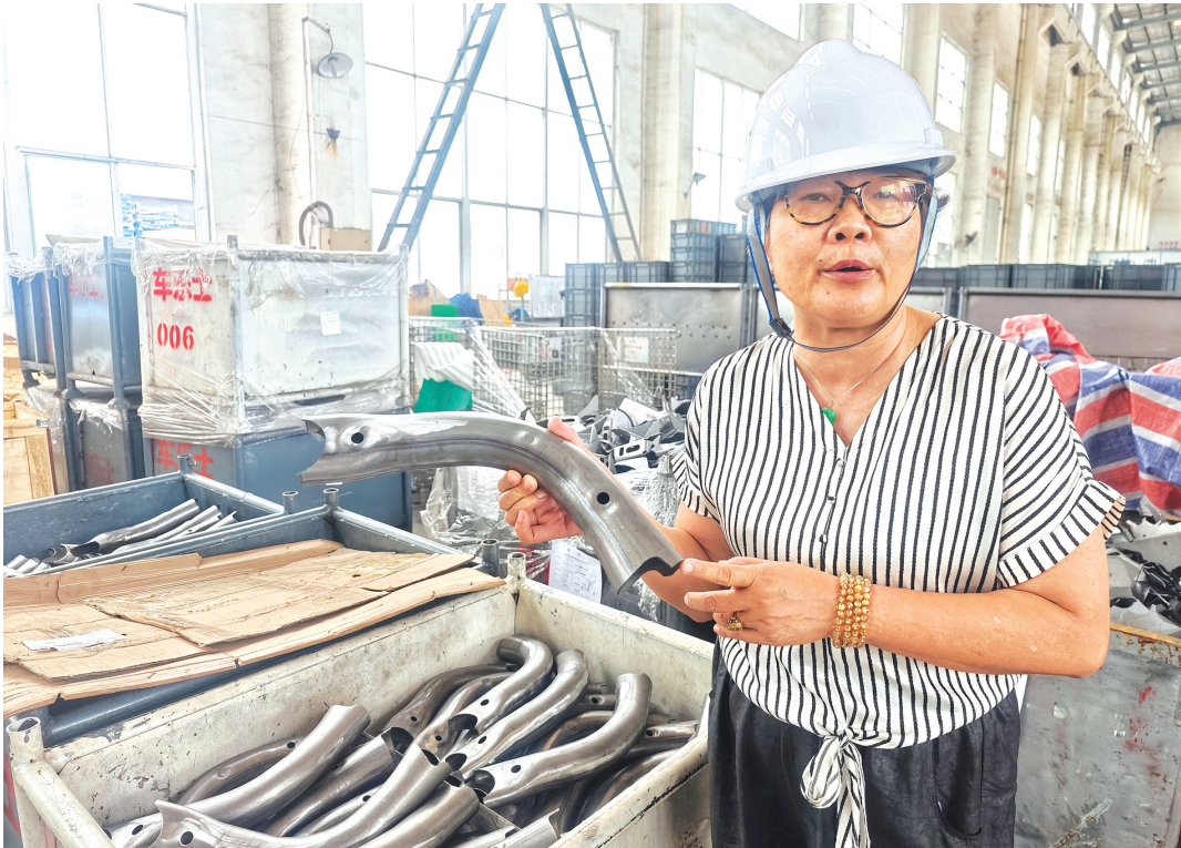
黄小燕向记者介绍手中使用内高压成形技术生产的特形管件。
