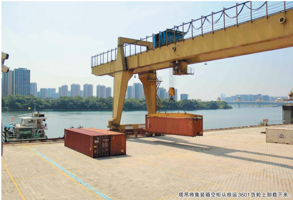
塔吊将集装箱空柜从桂运3601货轮上卸载下来。
