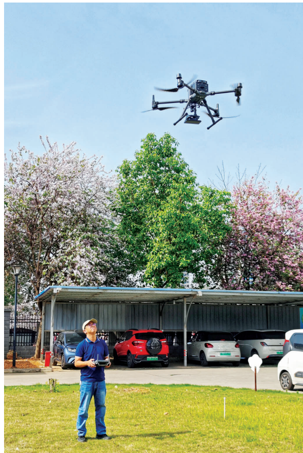
覃汉章操控安装好电波流速仪的无人机起飞。
