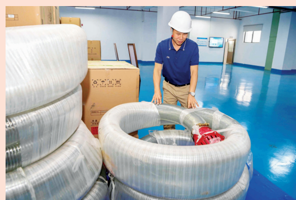
检查汽油抽水机配套吸水管。
