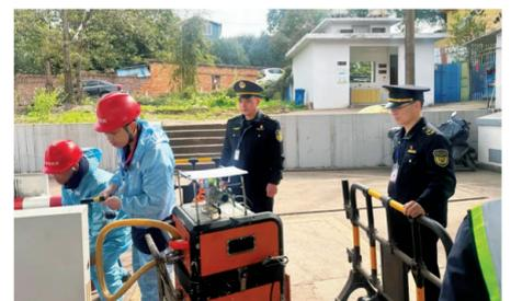
执法人员指导第三方检测机构对油气回收设备进行抽测。（市生态环境局提供）
