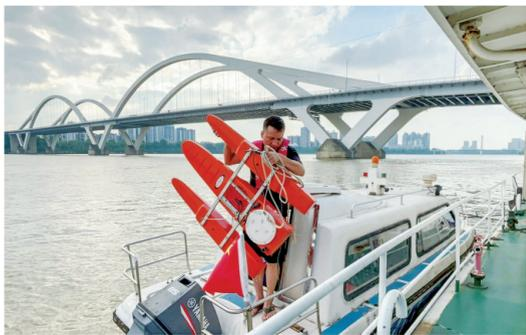
市水文中心站工作人员把走航式ADCP搬运上船，为测定河流断面流速和流量做准备。
