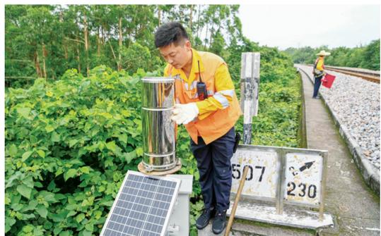
工作人员查看铁路沿线设置的雨量计，确保仪器正常运行。
