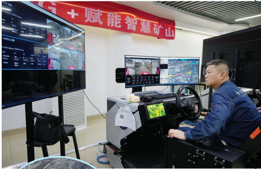
↑7月9日，在位于攀枝花的攀钢集团矿业朱兰铁矿分公司5G操控大厅里，矿工坐在智控座舱中，通过5G网络远程操控着矿山机械采矿。
