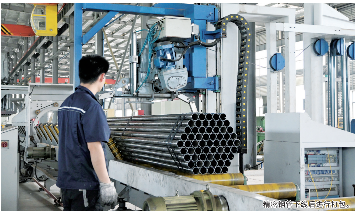
精密钢管下线后进行打包。
