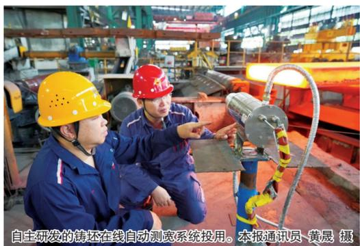
自主研发的铸坯在线自动测温系统投用。本报通讯员 黄晨 摄
