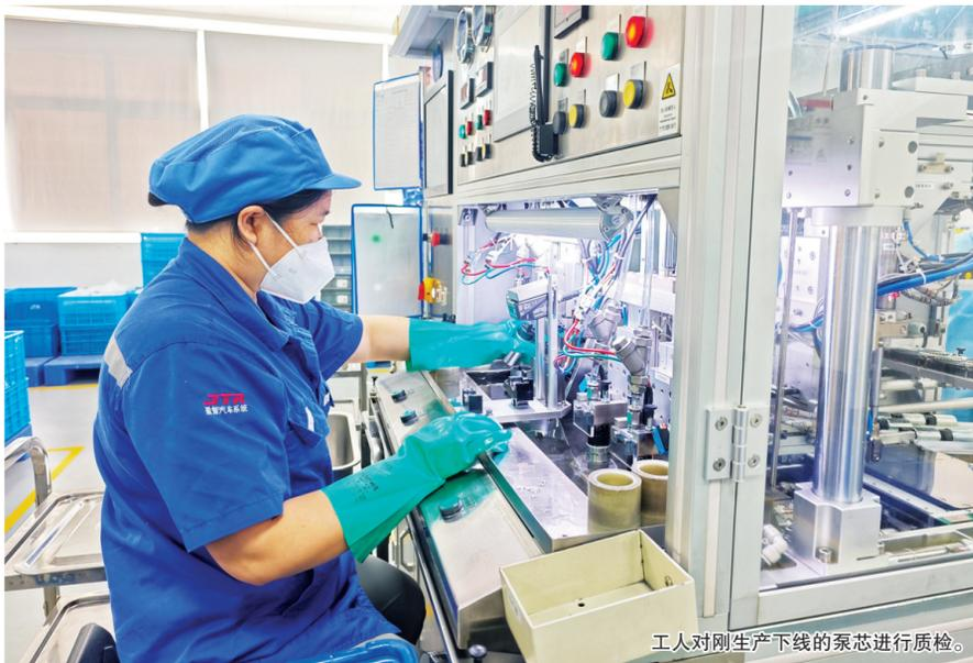
工人对刚生产下线的泵芯进行质检。
