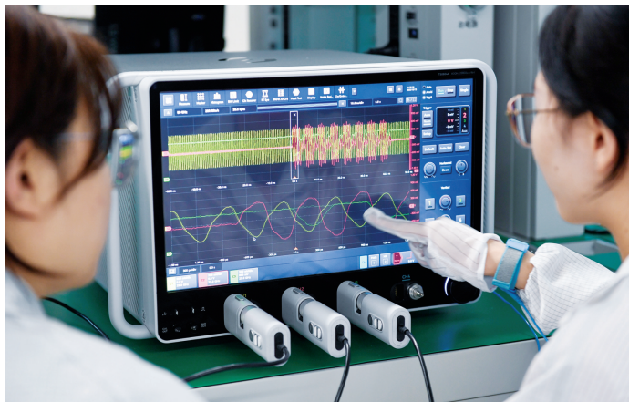
10月13日，在深圳市万里眼技术有限公司，实验室人员在测试DDR5接口信号。（新华社发）
