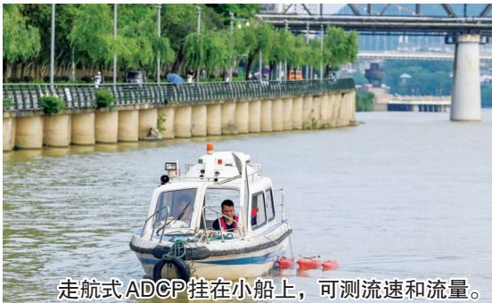
走航式 ADCP 挂在小船上，可测流速和流量。
